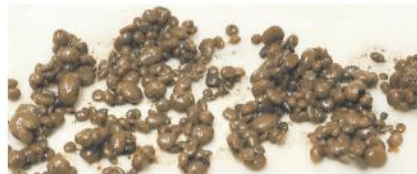
Die körnige Biomasse setzt sich unter dem sauberen Wasser ab.
